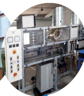
1 CTA avec une batterie de préchauffage et un caisson de mélange
