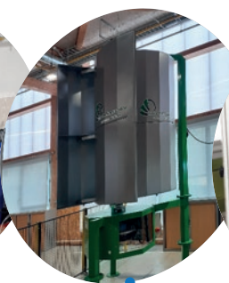
Éolienne verticale et banc de test
